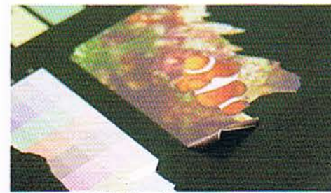
⑤テフロン加工した治具なら、インクがバリバリに固まらず、薄いゴムのようなになるので、キレイに剥がすことができる。塗り足してプリントするクセのある業者は喉から手が出るほど欲しいはず。
